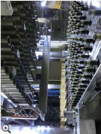
Blick von der Entnahmeeinrichtung zur kalten Seite des 192-fach-Werkzeug
